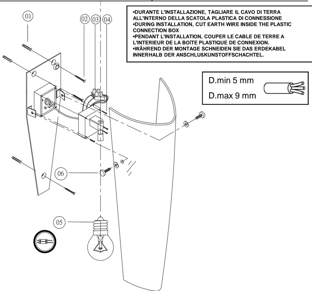
•DURANTE L'INSTALLAZIONE, TAGLIARE IL CAVO DI TERRA ALL'INTERNO DELLA SCATOLA PLASTICA DI CONNESSIONE
