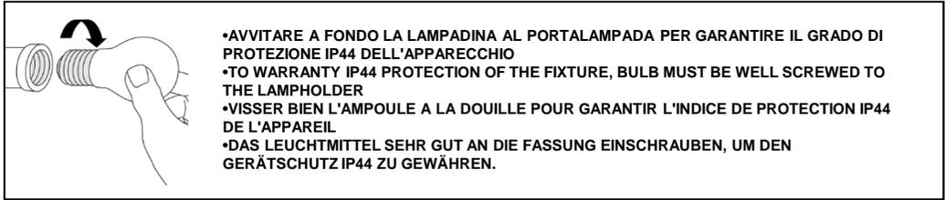
•AVVITARE A FONDO LA LAMPADINA AL PORTALAMPADA PER GARANTIRE IL GRADO DI PROTEZIONE IP44 DELL'APPARECCHIO
