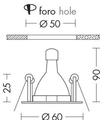
Faretto 12V ad incasso tondo o quadrato, con attacco GU4 che consente di montare lampadina LED o a risparmio energetico. Struttura in metallo, disponibile in quattro finiture: bianco, cromo, nero e nickel opaco. Necessita di alimentatore da installare in remoto (pag.565 - 570). Cassaforma per installazione in muratura da ordinare come accessorio (pag.590).
