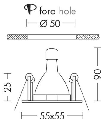
Faretto 12V ad incasso tondo o quadrato, con attacco GU4 che consente di montare lampadina LED o a risparmio energetico. Struttura in metallo, disponibile in quattro finiture: bianco, cromo, nero e nickel opaco. Necessita di alimentatore da installare in remoto (pag.565 - 570). Cassaforma per installazione in muratura da ordinare come accessorio (pag.590).
