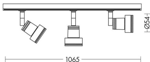
Kit di spot comprendente binario monofase da 1mt SQUASH (pag.268), testata di alimentazione laterale, tappo di chiusura e tre proiettori orientabili in pressofusione di alluminio con attacco GU10 che consente di montare lampadina LED o a risparmio energetico. Proiettori regolabili e orientabili di 355° rispetto all'asse orizzontale e di 180° rispetto all'asse verticale. Disponibile in due finiture: bianco e nero.
