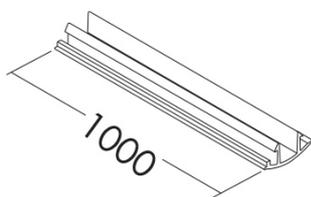
Binario trifase e DALI a tensione di rete (230/440V-16A), a tripla accensione, con sezione quadrata. Applicabile a parete, plafone, sospensione o a incasso con appositi accessori. Realizzato in lega di alluminio estruso, conduttori in rame alloggiati in estrusi in PVC. Disponibile in tre dimensioni e tre finiture: bianco, grigio e nero. Anche nella versione DALI ? possibile l'installazione a sistema con giunti lineari e angolari.
