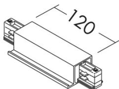
Binario trifase e DALI a tensione di rete (230/440V-16A), a tripla accensione, con sezione quadrata. Applicabile a parete, plafone, sospensione o a incasso con appositi accessori. Realizzato in lega di alluminio estruso, conduttori in rame alloggiati in estrusi in PVC. Disponibile in tre dimensioni e tre finiture: bianco, grigio e nero. Anche nella versione DALI ? possibile l'installazione a sistema con giunti lineari e angolari.
