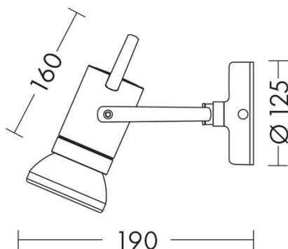
Proiettore con basetta, installabile a parete e plafone, con attacco PAR E27 che consente di montare lampadina LED o a risparmio energetico. Corpo e staffe in pressofusione di alluminio, regolabile e orientabile di 355° rispetto all'asse orizzontale e rispetto all'asse verticale di 45° verso l'alto e di 90° verso il basso. Disponibile in tre finiture (bianco, grigio e nero).
