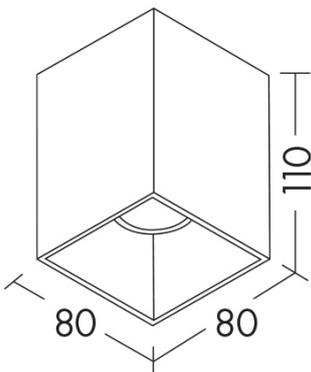
Apparecchio a plafone con attacco GU10 che consente di montare lampadina LED o a risparmio energetico. Struttura tonda o quadrata in pressofusione di alluminio verniciato con polveri epossidiche ad elevata resistenza. Disponibile in cinque finiture (bianco, grigio, nero, bianco e nero con interno oro satinato).
