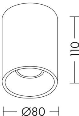
Apparecchio a plafone con attacco GU10 che consente di montare lampadina LED o a risparmio energetico. Struttura tonda o quadrata in pressofusione di alluminio verniciato con polveri epossidiche ad elevata resistenza. Disponibile in cinque finiture (bianco, grigio, nero, bianco e nero con interno oro satinato).
