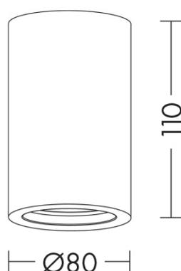
Apparecchio a plafone con attacco GU10 che consente di montare lampadina LED o a risparmio energetico. Struttura in gesso che consente la pittura del corpo in tinta a scelta. Disponibile in forma tonda o quadrata.
