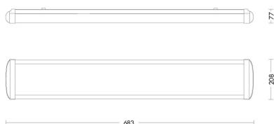
Apparecchio LED monoemissione. Corpo in lamiera d'acciaio, spessore di soli 77mm, schermo diffusore in PMMA semiopale e testate in materiale plastico. Disponibile in due temperature colore (3000K e 4000K), tre dimensioni e relative potenze. Alimentatore a bordo. Prodotto che si presta all'illuminazione generale e diffusa. Disponibili giunti certificati IP68 per la realizzazione delle connessioni elettriche, sicure, durevoli e con barriera anticondensa (pag.589).
