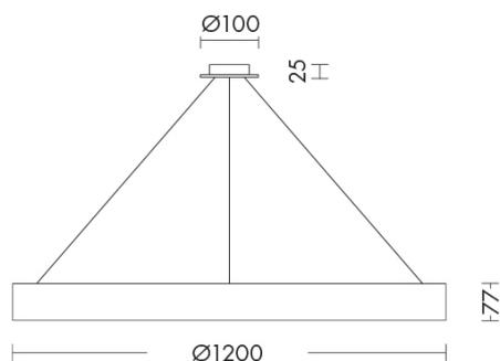
Apparecchio LED a sospensione tondo monoemissione (a luce diretta) e biemissione. Corpo in alluminio con diffusore opale, disponibile in due finiture (bianco e nero) e due temperature colore (3000K e 4000K). Disponibile in due misure che permettono di realizzare originali composizioni geometriche.
