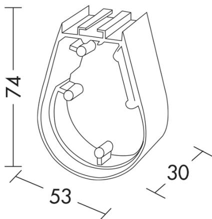
Apparecchio LED a soffitto, a sospensione e a parete. Corpo in alluminio estruso dalla forma trapezoidale con schermo in policarbonato opale curvo. Possibilit? di configurazione in linea. In posizione verticale il flusso luminoso ? di 270?. Disponibile in tre lunghezze e relative potenze, due temperature colore (3000K e 4000K) e in due finiture (bianco e grigio).
