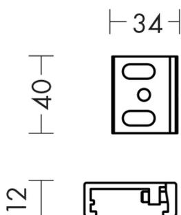
Binario trifase e DALI a tensione di rete (230/440V-16A), a tripla accensione, con sezione quadrata. Applicabile a parete, plafone, sospensione o a incasso con appositi accessori. Realizzato in lega di alluminio estruso, conduttori in rame alloggiati in estrusi in PVC. Disponibile in tre dimensioni e tre finiture: bianco, grigio e nero. Anche nella versione DALI ? possibile l'installazione a sistema con giunti lineari e angolari.
