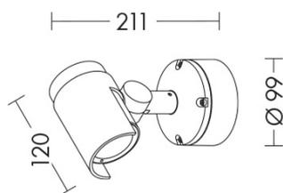
Proiettore LED orientabile per esterno, applicabile a plafone, parete e terra con apposito picchetto in dotazione. Struttura in pressofusione di alluminio verniciato con polveri poliestere ad elevata resistenza ai raggi ultravioletti e alla corrosione. Disponibile nella finitura antracite e in due temperature colore (3000K e 4000K). Disponibili giunti certificati IP68 per la realizzazione delle connessioni elettriche, sicure, durevoli e con barriera anticondensa (pag.589).
