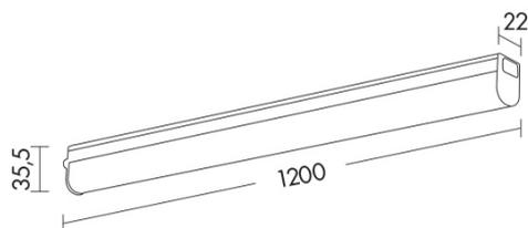
Reglette a LED a luce diretta, per applicazione a parete o plafone, particolarmente adatta per installazione sui mobili. Corpo in alluminio verniciato bianco e schermo in policarbonato opale e alimentatore integrato. Corredato di cavo di alimentazione (lungo 1,8mt) con spina europea e giunto di connessione flessibile elettrificato bianco. Clip di montaggio e viti incluse. Accensione on/off posta sulla struttura.
