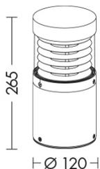
Paletto LED per esterno, struttura in pressofusione di alluminio, verniciato con polveri poliestere ad elevata resistenza ai raggi ultravioletti e alla corrosione. Diffusore in policarbonato con griglia frangiluce. Alimentatore LED integrato. Disponibile in due altezze, tre finiture (antracite, grigio e marrone) e due temperature colore (3000K e 4000K). Disponibili giunti certificati IP68 per la realizzazione delle connessioni elettriche, sicure, durevoli e con barriera anticondensa (pag.589).
