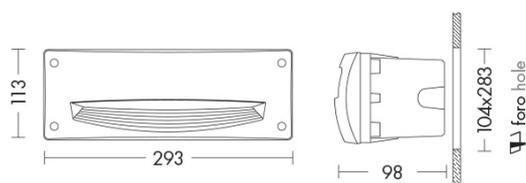
Incasso a parete per esterno segnapasso, con lampadina LED GX53 inclusa. Realizzato in policarbonato antiurto stabilizzato ai raggi UV, inattaccabile da ruggine e corrosione. Diffusore opale in metacrilato con guarnizione in gomma siliconica (IP66). Disponibile in tre dimensioni, due finiture (grigio e nero), 3000K e 4000K. Disponibili giunti certificati IP68 per la realizzazione delle connessioni elettriche, sicure, durevoli e con barriera anticondensa (pag.589).
