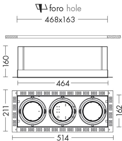
Faretto ad incasso a scomparsa (rasato) da installare in cartongesso cardanico, orientabile su due assi  $\pm 30^\circ/\pm 360^\circ$ . Struttura in alluminio verniciato. Disponibile nella versione ad uno, due o tre elementi con attacco GU10 o con attacco G53 per lampadina AR111 (portalampada per lampadina AR111 con attacco GU10 incluso). Disponibile in due finiture: bianco e nero. La versione 12V necessita di alimentatore da installare in remoto (pag.565 - 570).
